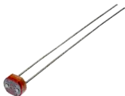
Photographie d'une photorésistance et de ses deux bornes
