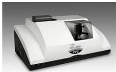
L'appareil ci-contre permet de mesurer la taille de particules allant de 40 nm à 2500 µm tout en occupant un encombrement extrêmement réduit. Le fabricant de l'appareil indique que deux diodes laser de longueurs d'onde 635 nm et 830 nm sont utilisées dans cet instrument de mesure.
