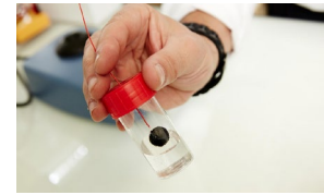
Biopile à glucose implantable dans le corps humain
