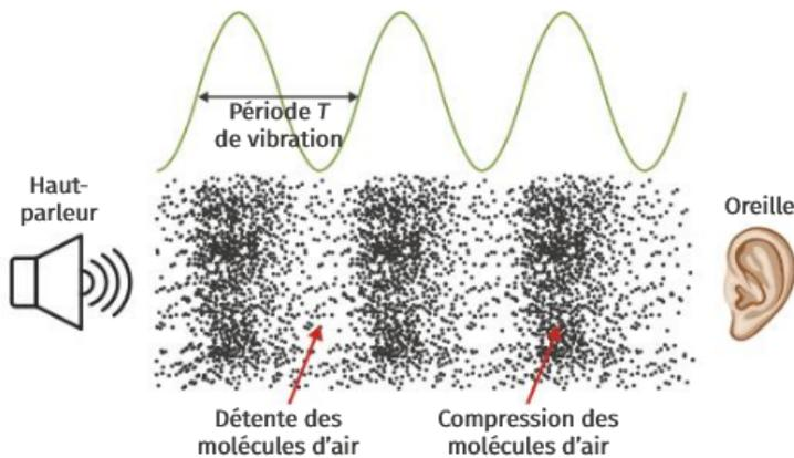
Un signal sonore résulte de la mise en vibration des molécules ou des atomes d'un milieu de propagation.
