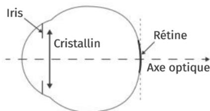
La première est l'iris dont le trou central appelé pupille est de diamètre variable, permettant ainsi de contrôler la quantité de rayons lumineux arrivant dans l'œil. On le modélise par un diaphragme.
